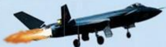
歼-20 (隐形战机) 2011年1月试飞成功 全长22米、机翼长度13.7米、起飞重量34,000公斤
